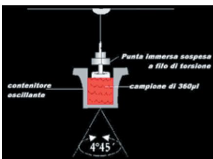
Рис. 1. Принцип измерения TEG5000
